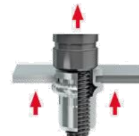
Insertion et sertissage de l'écrou à sertir
