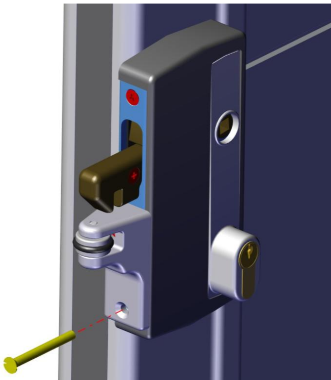
Effectuez le serrage du cylindre à l'aide de la vis inox tête fraisée M5x70
