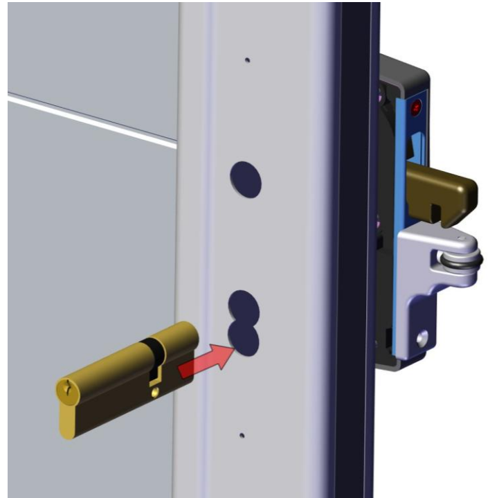
Mettez en place le cylindre
