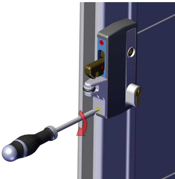
Effectuez le serrage du cylindre à l'aide de la vis inox tête fraisée M5x70
