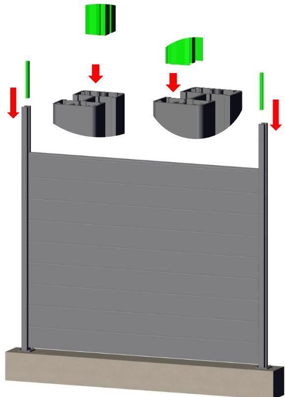
Etape 4: Faites glisser la tôle décor jusqu'au fond de la rainure du profil jonc
