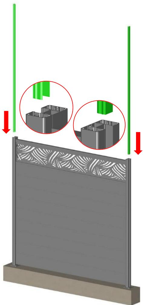
Etape 9: Mettez en place le profil U finition (coupé à la longueur de l'entre poteaux à l'aide d'une scie à métaux) et le coller avec des points silicone au dessus du profil Clastra
