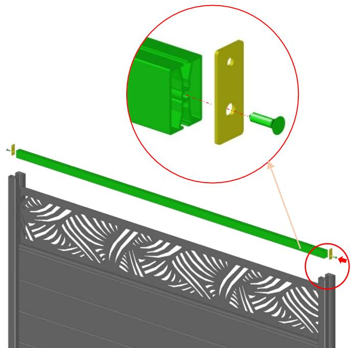
Etape 6: Faites glisser le profil claustra jusqu'à être en appui sur les closoirs tôle
