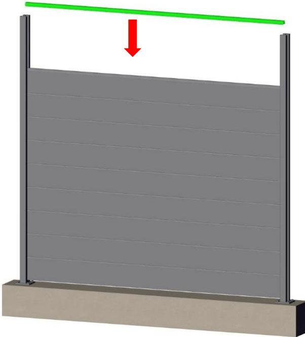
Etape 3: Faites glisser les deux closoirs tôle jusqu'au profil jonc
