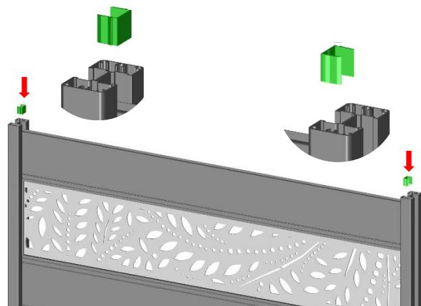
Etape 7: Mettez en place le profil U finition (coupé à la longueur de l'entre poteau à l'aide d'une scie à métaux) et le coller avec des points de silicone au dessus de la dernière lame de la partie haute.
