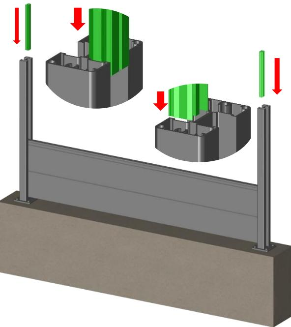
**Etape 3:** Faites glisser la tôle décor jusqu'au fond de la rainure du profil jonc.
