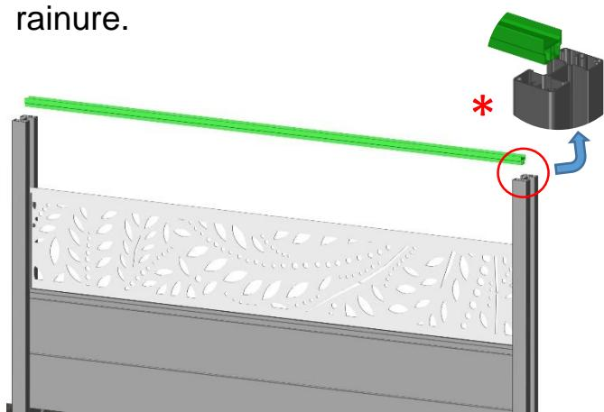
Etape 5: Faites glisser la première lame de la partie haute (\* lame tête en bas) jusqu'au profil jonc.
