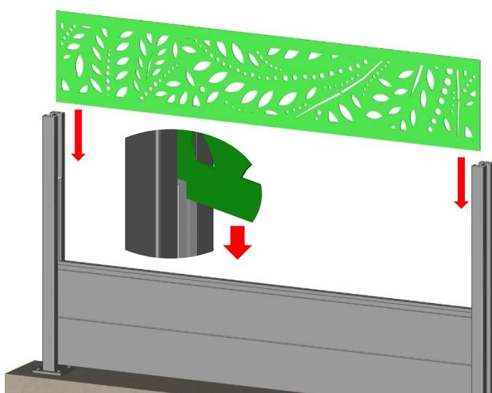
Etape 4: Faites glisser le profil jonc (\* partie rainuré vers le bas) jusqu'à ce que la tôle décor soit en fond de rainure.
