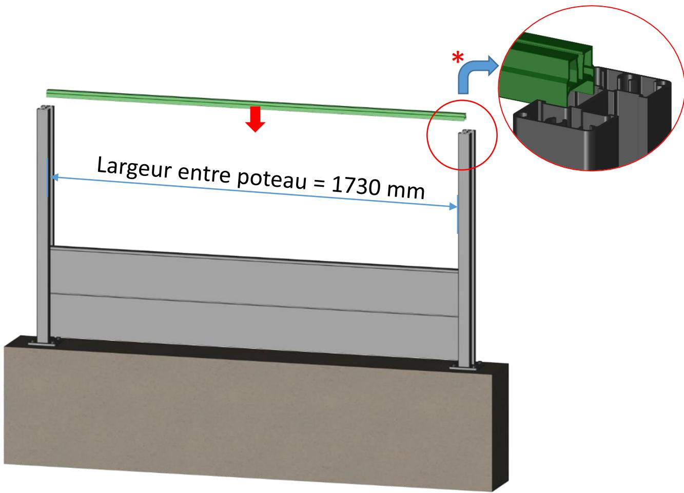
**Etape 2:** Faites glisser les deux closoirs tôle jusqu'au profil jonc
