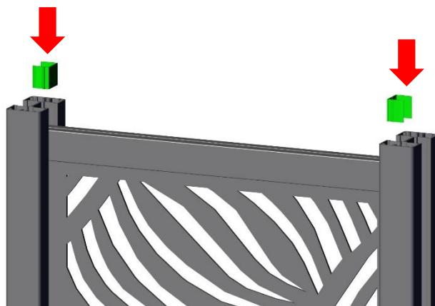
Etape 10: Mettez en place le profil U finition (coupé à la longueur de l'entre poteaux à l'aide d'une scie à métaux) et le coller avec des points silicone au dessus du profil Claustra
