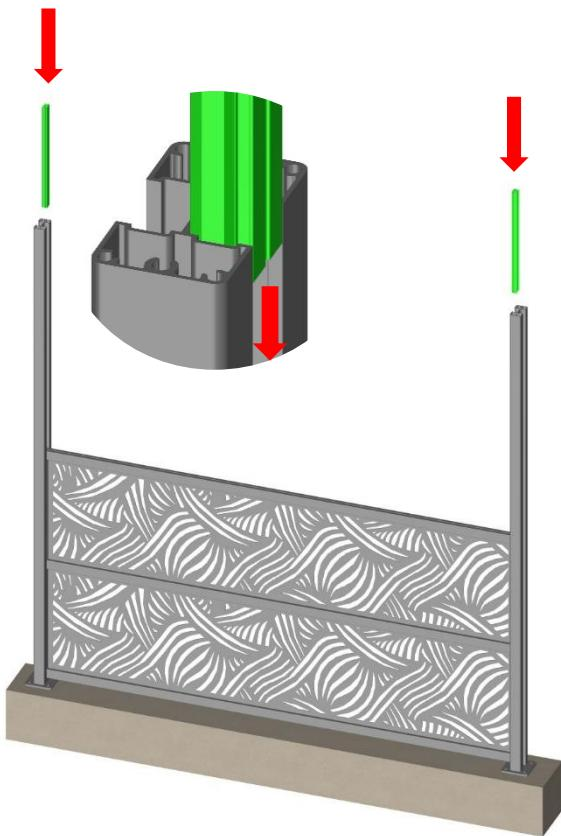
Etape 9: Faites glisser un profil claustra jusqu'à être en appui sur les closoirs tôle
