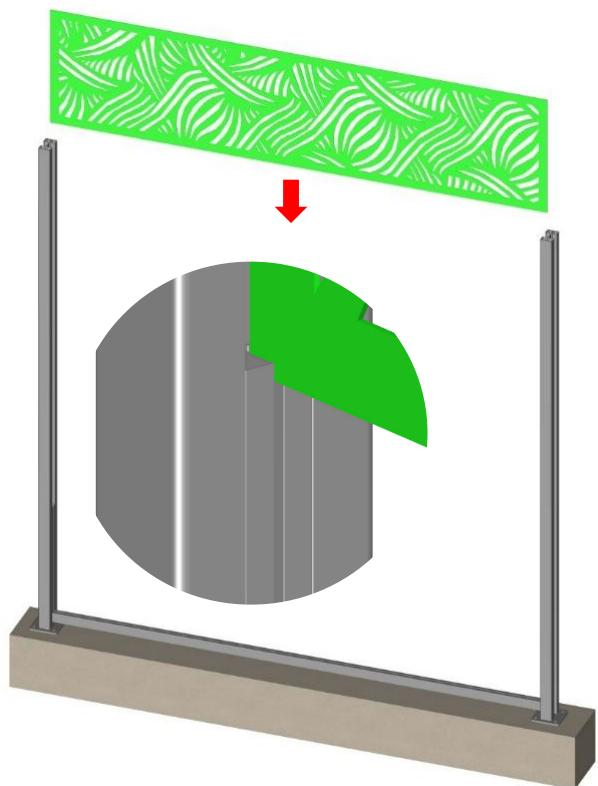
Etape 6: Faites glisser un profil claustra jusqu'à être en appui sur les closoirs tôle
