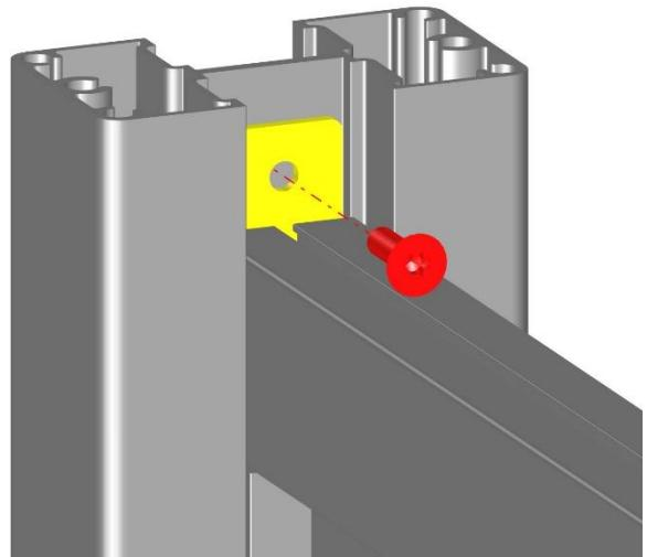
Etape 19: Mettez en place le profil U finition (coupé à la longueur de l'entre poteaux à l'aide d'une scie à métaux) et le coller avec des points silicone au dessus du profil Claustra
